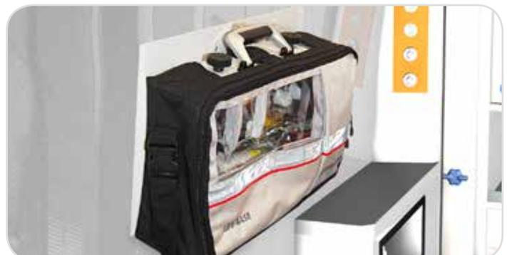
Durch ihr kleines, kompaktes Format hat LIFE-BASE Mini II eine hohe Standfestigkeit und eignet sich besonders für den Einsatz bei beengten Raumverhältnissen. Die Montage der Geräte erfolgt schräg. Dadurch ergibt sich eine nochmals verbesserte Bedien- und Ablesbarkeit.
